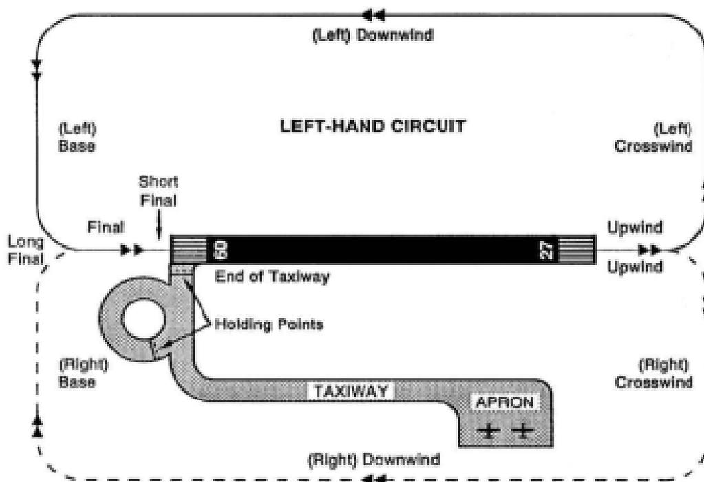
FIG 5.1. - RIGHT HAND/LEFT HAND CIRCUITS
